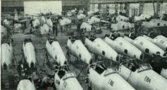
Bf 109E production line at Augsburg.
